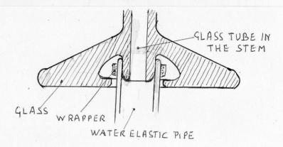
THE WRAPPER FASTENS THE PIPE TO THE GLASS TUBE
